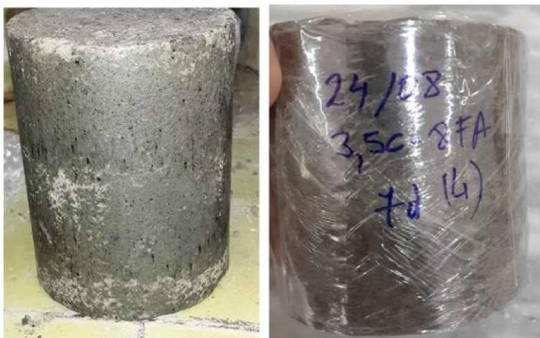
Figura 3.10: Kampioni i ngjeshur dhe i mbështjellë në letër polietileni për procesin e maturimit
