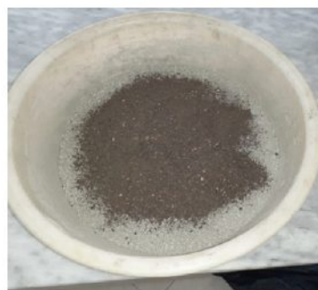
Figura 3.9: Procesi i përzierjes së argjilës me çimento dhe hi qymyror
