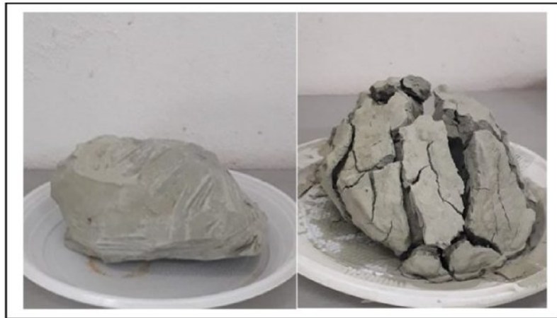
Figura 4.28: Kampioni i argjilës rrënjësore para dhe pas ciklit të parë
