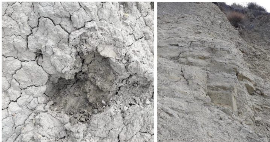
Figura 3.2: Paraqitje e gjendjes së argjlave in-situ: (majtas) edhe pse e thatë në sipërfaqe, në brendësi përmban ujë; (djathtas) zhvillimi i sistemit të çarjeve në faqen vertikale të shpatit
