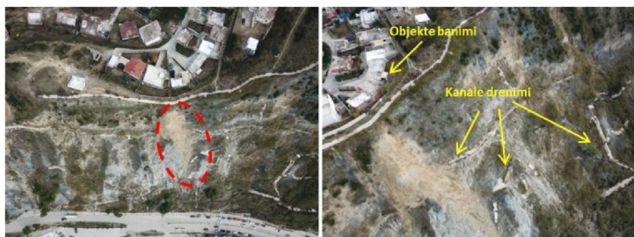
Figura 5.8: Foto me drone ku dallohen rrëshqitjet aktive pranë zonave të banuara dhe dëmtimet në kanalet e drenimit
